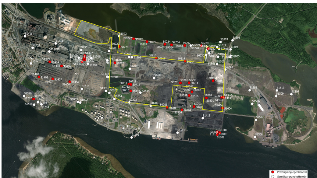
Figur 17 Karta där provtagningspunkter för grundvatten och egenkontroll visualiseras. Ungefärlig plangräns i gult.
