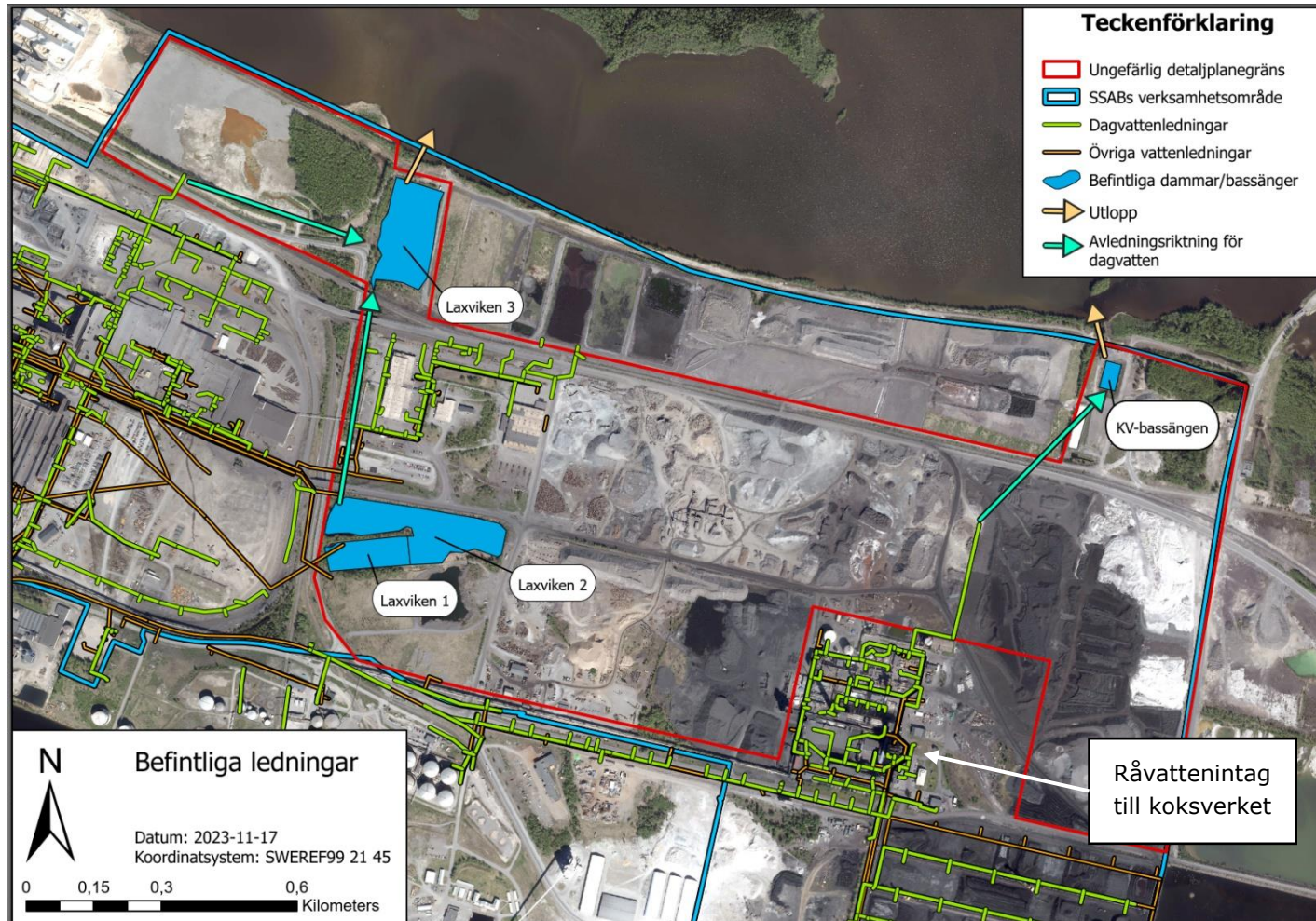
Figur 5-1. Ledningsnät inom detaljplaneområdet och SSABs verksamhetsområde samt befintliga dammar och bassänger. Blå pil indikerar riktning för avledning där diken inte är tydliga, underlag saknas och där tolkning av avledning har gjorts utifrån uppgifter från SSAB.
